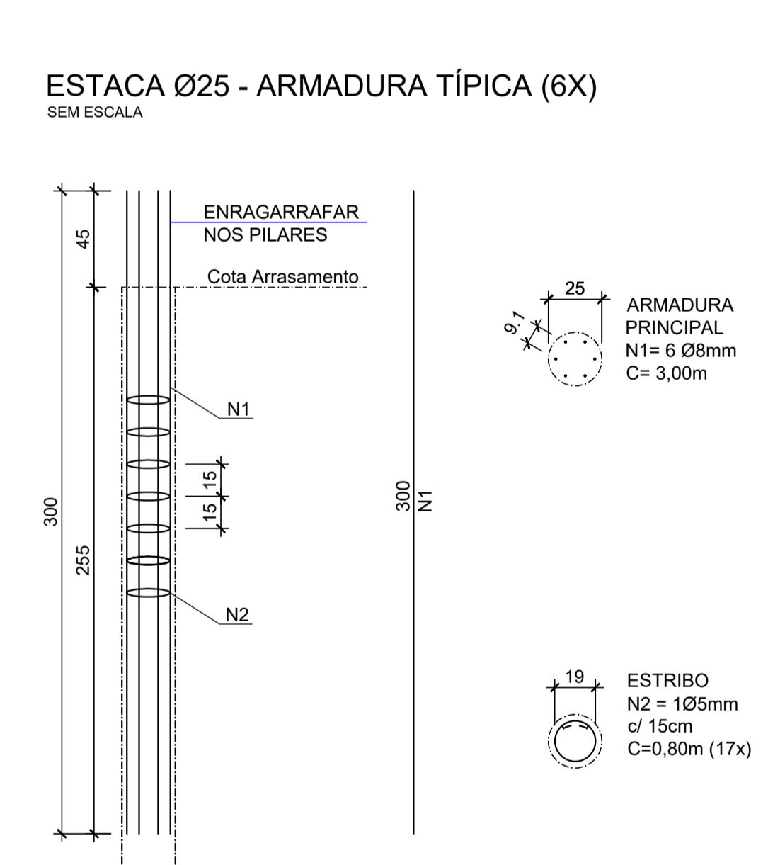
A PRESENTE ARMADURA REFERE-SE APENAS À PARTE SUPERIOR DA ESTACA NÃO DE TERMINANDO O SEU COMPRIMENTO TOTAL O COMPROVADO TÉCNICO PELA EXECUÇÃO DA MESMA. DEVERÁ SER DETERMINADO POR RESPONSÁVEL TÉCNICO.
